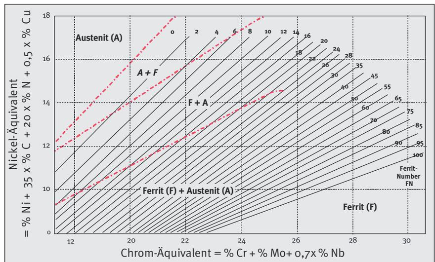
Bild 5: WRC-Diagramm zur Ermittlung der Ferritgehalte bei höheren Ferritnummern FN
