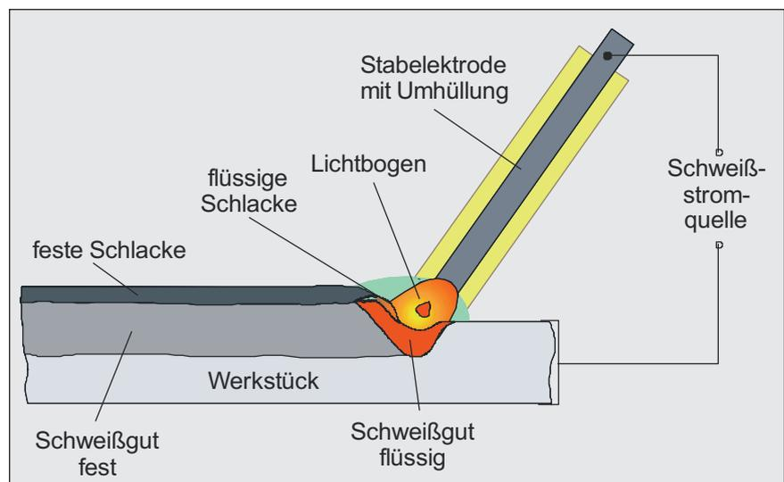
**Bild 9:** Schweißen mit umhüllten Stabelektroden
