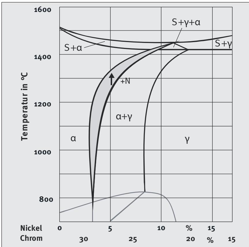
Bild 6: Quasibinärer Schnitt durch das System Eisen-Nickel-Chrom bei einem Eisen-gehalt von etwa 77,5%. Deutlich ist die Verschiebung der Austenitbildung zu höheren Temperaturen durch die Zugabe von Stickstoff zu erkennen (graue Fläche)
