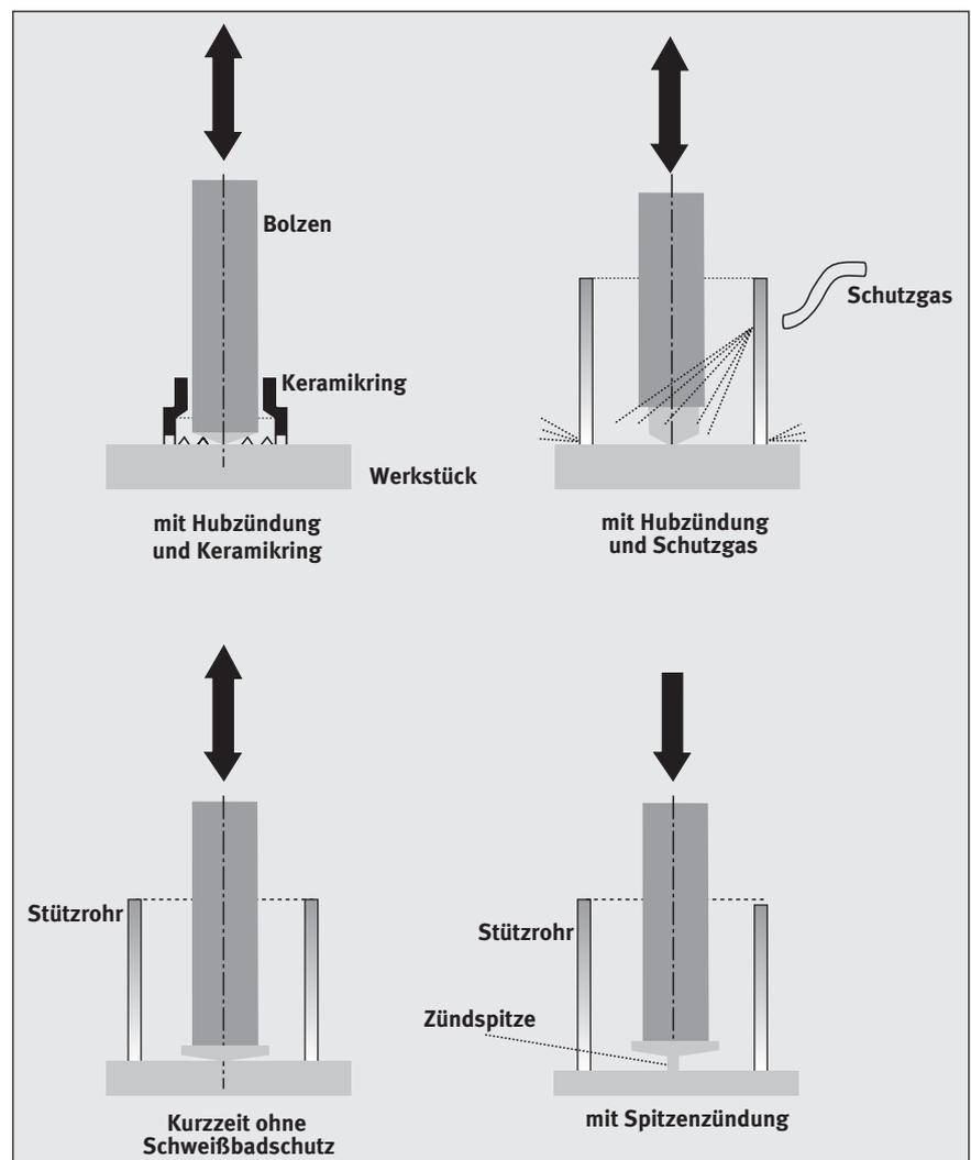
Bild 19: Die wichtigsten Verfahrensvarianten beim Lichtbogenbolzenschweißen
