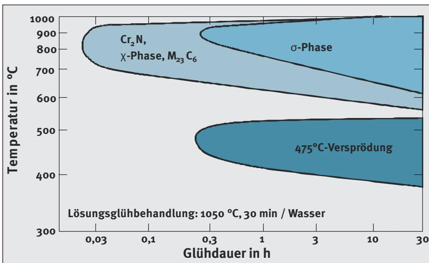
Bild 7: Zeit-Temperatur-Ausscheidungsdiagramm für den austenitisch-ferritischen Duplex-Stahl X2CrNiMoN22-5-3 (1.4462)
