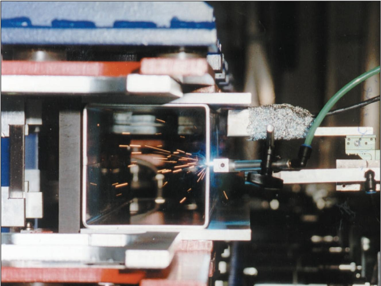
Bild 14: Schweißprozess mit CO<sub>2</sub>-Laser an speziell konfektionierten Edelstahlprofilen (tailored beams)
