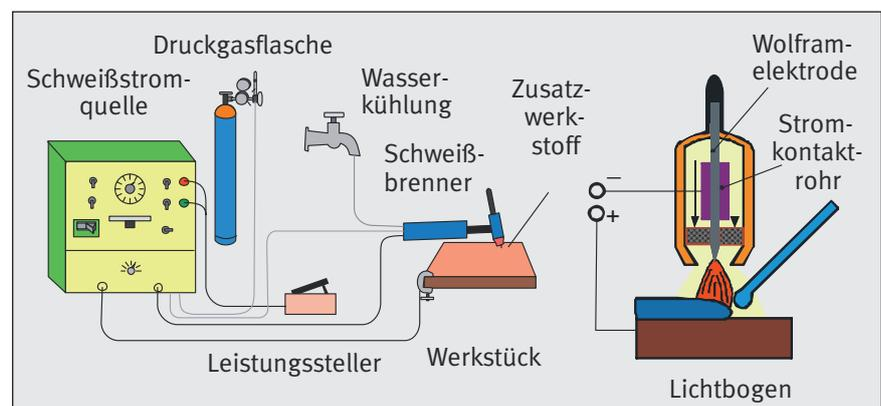
Bild 10: Schweißarbeitsplatz zum WIG-Schweißen: Werkstück, Lichtbogen, Schweißnaht, Zusatzwerkstoff, Gasdüse, Schutzgas, Kontaktrohr, Wolframelektrode, Stromquelle
