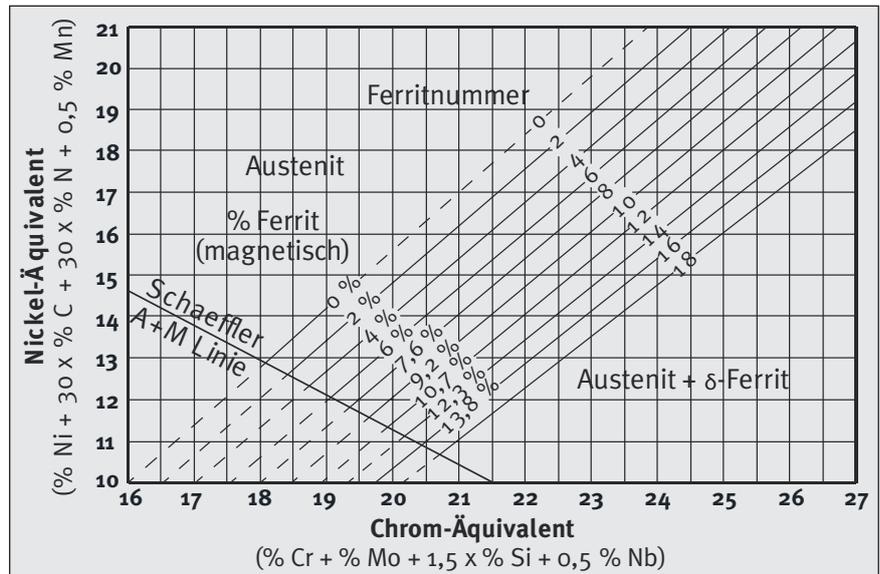
Bild 4: De-Long-Diagramm zur Bestimmung der Ferritnummer (Ferritzahl) in nicht-trosendem austenitischem Schweißgut als Ausschnitt des Schaeffler-Diagramms
