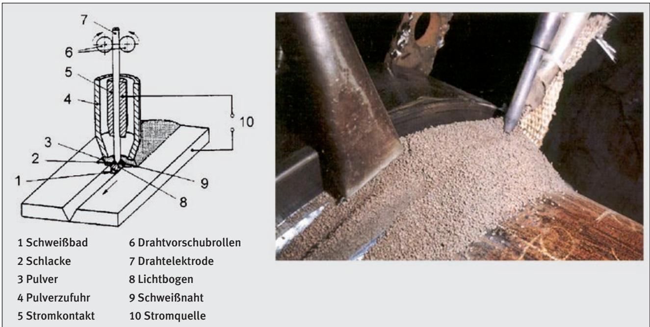
Bild 17: Unterpulver-Schweißen (UP)
