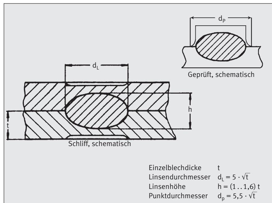
Bild 18: Angaben für empfohlene Abmessungen beim Widerstandspunktschweißen
