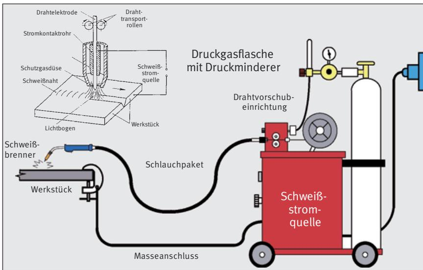
Bild 12: Schweißarbeitsplatz zum MSG-Schweißen
