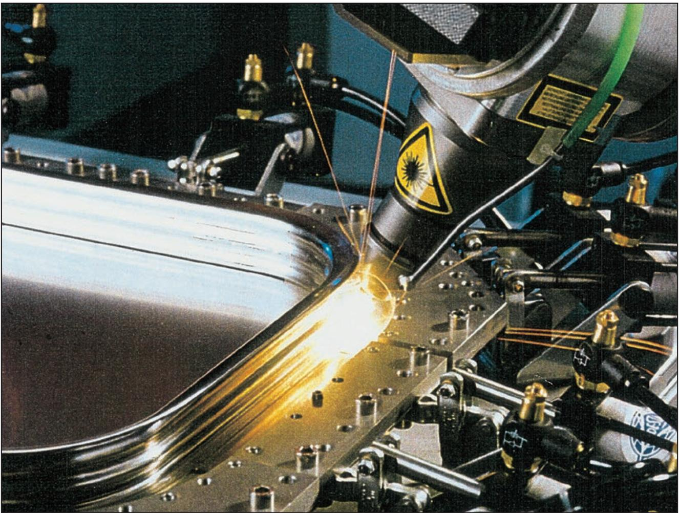
Bild 16: Schweißen von Membranringen mit einem Nd:YAG-Laser
