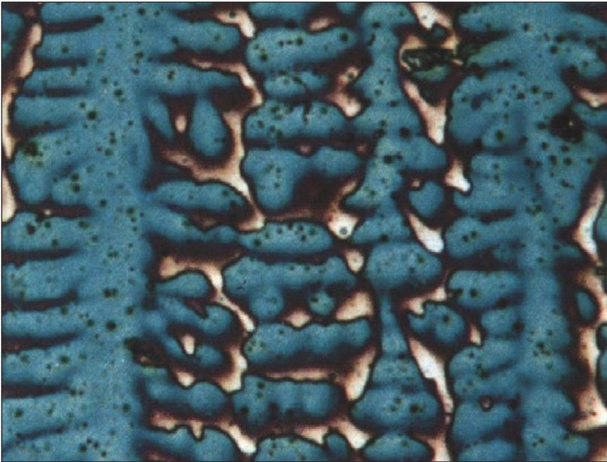
Bild 3: Dendritisch erstarrtes Schweißgut eines austenitischen Stahls mit  $\delta$ -Ferrit
