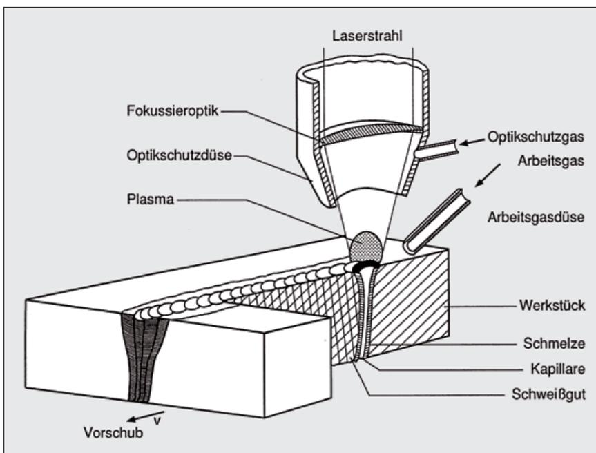
Bild 13: Laserstrahlschweißen
