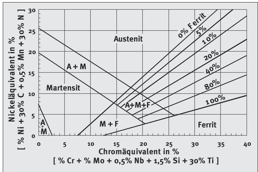
Bild 1: Schaeffler-Diagramm für Verbindungsschweißungen mit den entstehenden Phasen, ermittelt mit E-Handschweißung, Elektroden Durchmesser 5 mm, erweitert auch für andere wichtige Legierungselemente
