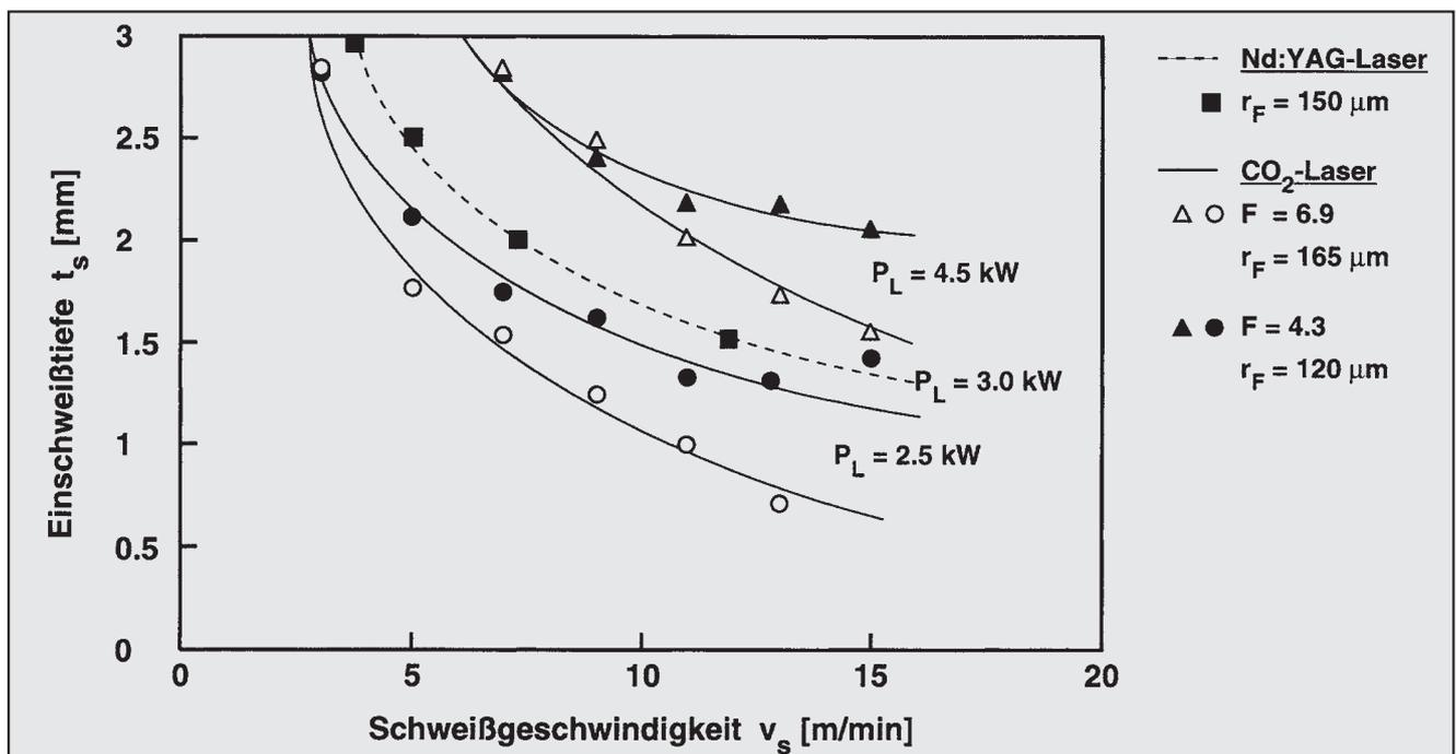
Bild 15: Einfluss von Leistung und Fokussierung auf den Schweißprozess am Beispiel eines 3 mm Bleches
