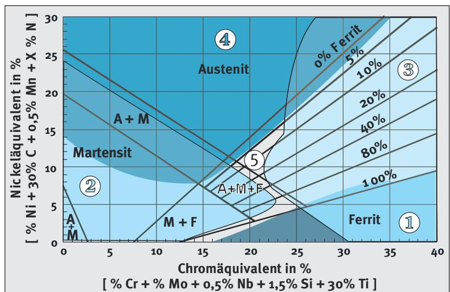
Bild 2: Beim Schweißen gefährdete Bereiche der nichtrostenden Stähle. Es bedeuten ① Gefahr des unkontrollierten Kornwachstums, ② Härterissbildung durch Martensitbildung, ③ Versprödung durch die Bildung von Sigma-Phase ( $\sigma$ -Phase) und ④ Heißrissbildung. Anm.: Die Wertigkeit des Elements Stickstoff variiert und ist für einfache austenitische Stähle zu vernachlässigen, für austenitisch-ferritische Duplexstähle beträgt der Faktor 16 und für voll-austenitische Stähle 30
