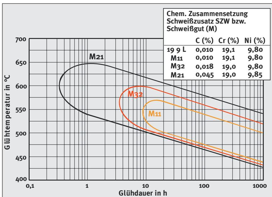
Bild 8: Sensibilisierung von Schweißgütern für interkristalline Korrosion durch Anreicherung von Kohlenstoff im Schweißgut durch  $\text{CO}_2$ -reiche Schutzgase
