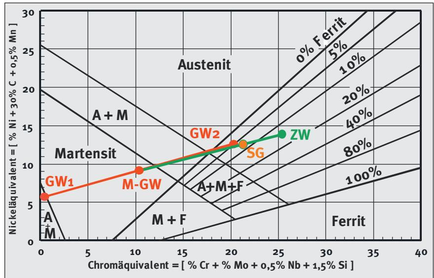
Bild 20: Schaefflerdiagramm mit den Äquivalenten der zu verschweißenden Grundwerkstoffe GW1 und GW 2 und dem Zusatzwerkstoff ZW, es wird ein Vermischungsgrad von 25% GW zu 75% Schweißzusatz angenommen
